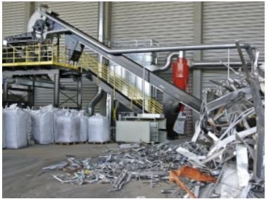
Die vollautomatische Aufbereitungsanlage (unten links) trennt mit einem Magneten das Eisen ab und filtert mit einem Wirbelstrom-Magneten die Nichteisenmetalle zwischen Holz, Glas und Plastik heraus. Foto: Anja Kummerow
